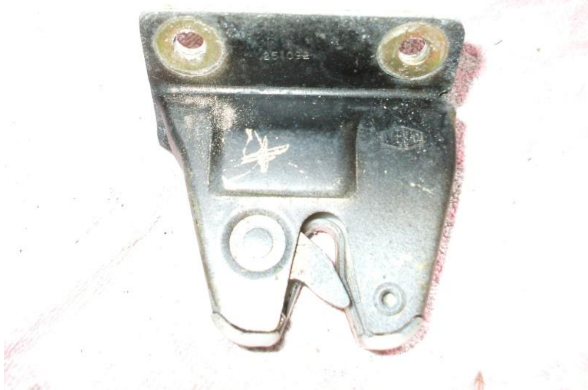
zavírací mechanismus zadních dveří
